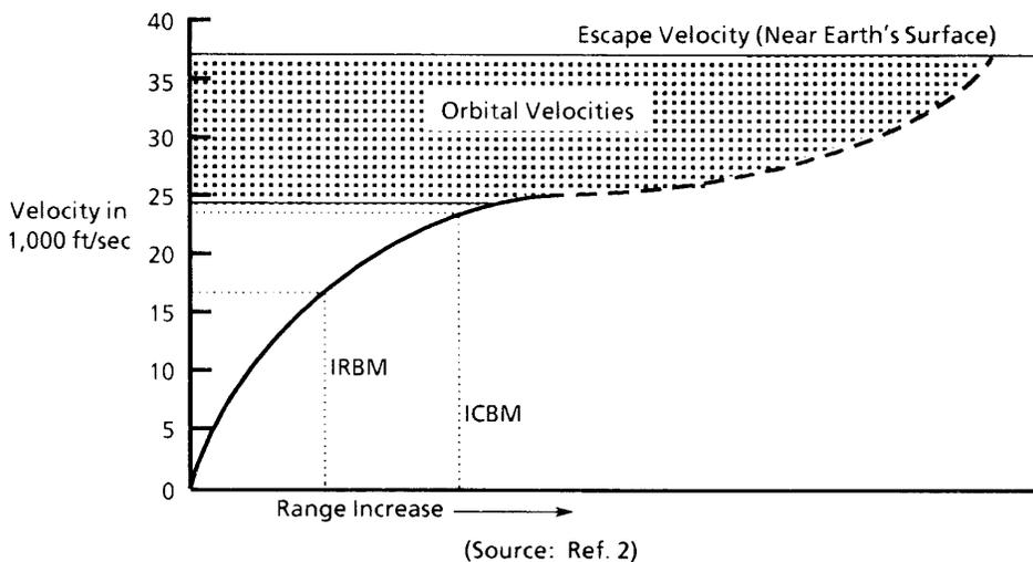
**FIGURE 4-7. VELOCITY vs. RANGE OF A ROCKET**
