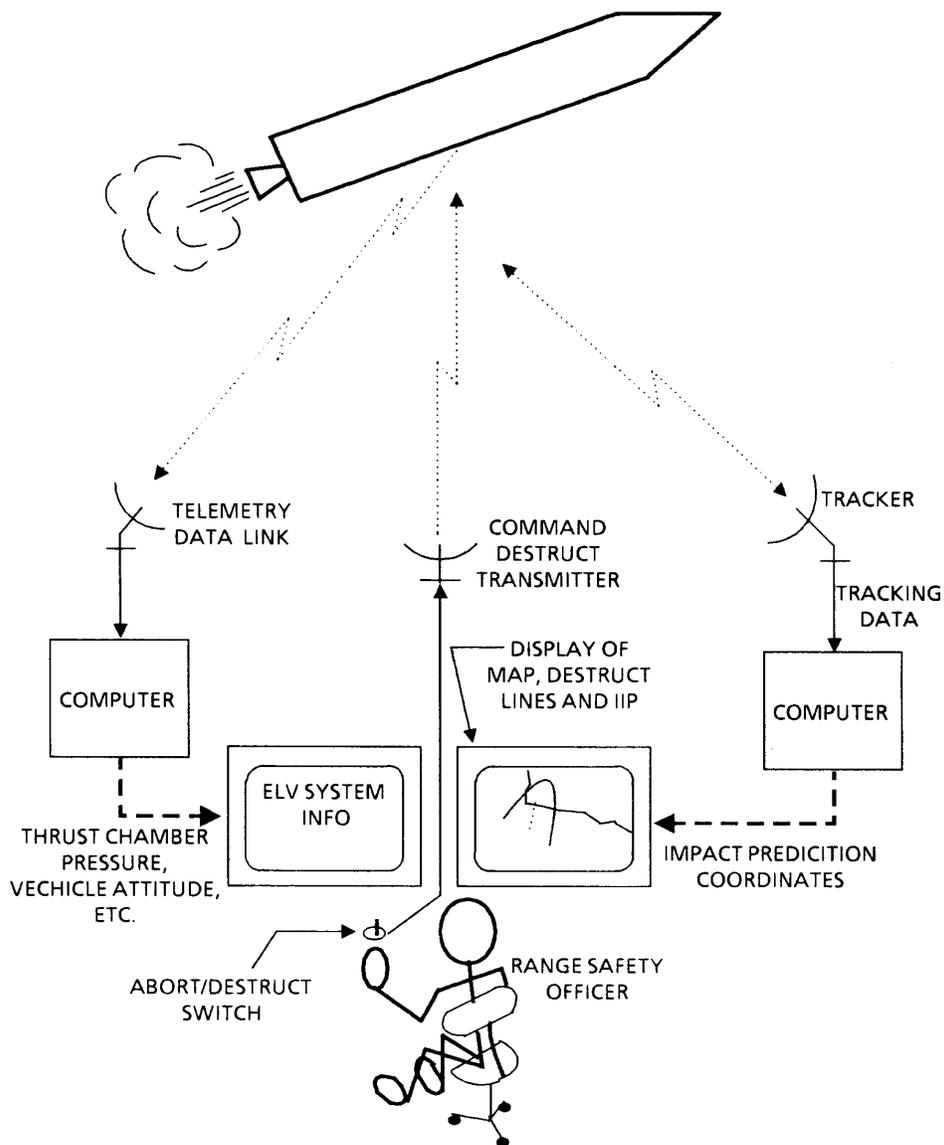
FIGURE 2-1. ELEMENTS OF THE FLIGHT CONTROL SYSTEM
