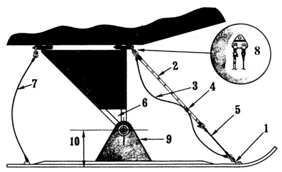
FIGURE 5-2. TYPICAL SKI INSTALLATION
