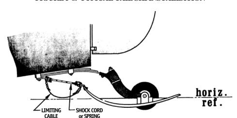
FIGURE 5-8. TYPICAL TAIL SKI INSTALLATION
