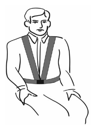
FIGURE 9-9. THE 5-POINT HARNESS POSITIONING
