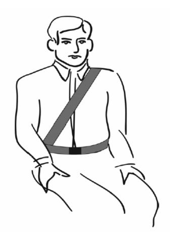
FIGURE 9-3. SIDE MOUNTED SINGLE DIAGONAL TYPE HARNESS
