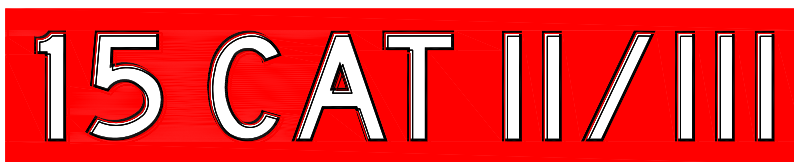
(d) Holding Position Sign for CAT II/III Operations
