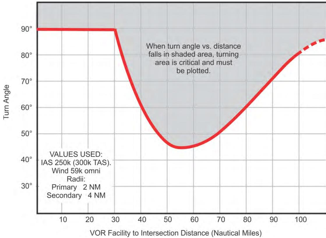
Figure 14-1-6. Fix Displacement
