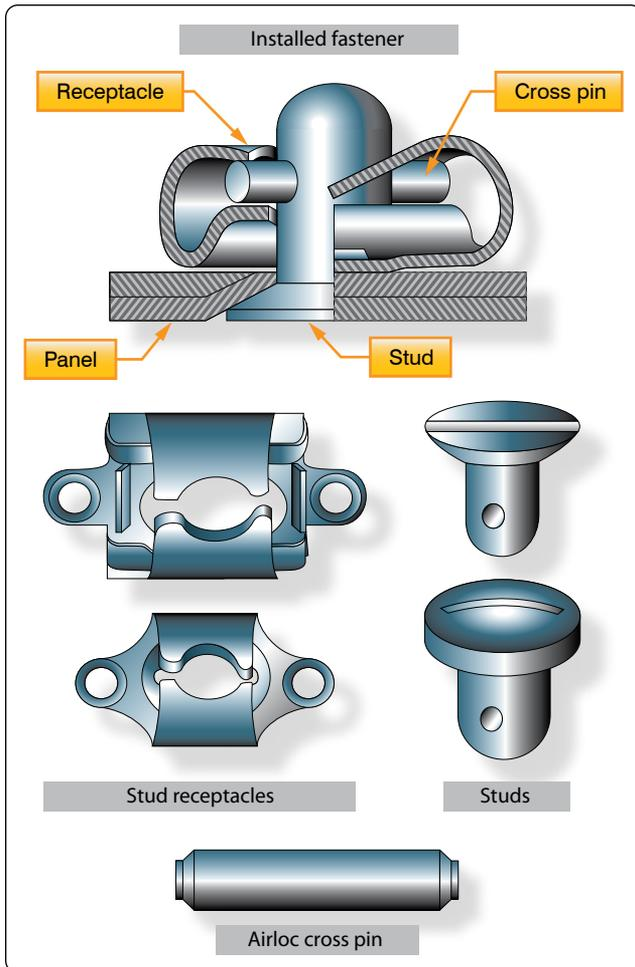
**Figure 7-61.** Airloc fastener.
