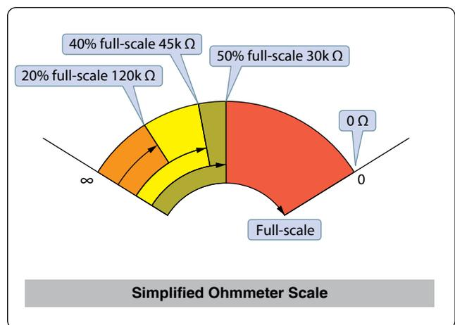
Figure 12-156. Ohm scale.
