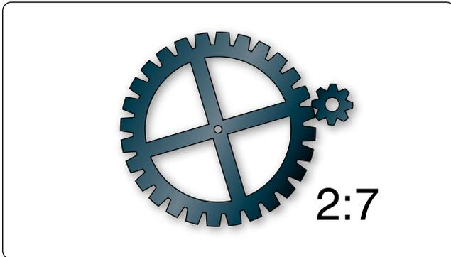
Figure 3-7. Gear ratio.
