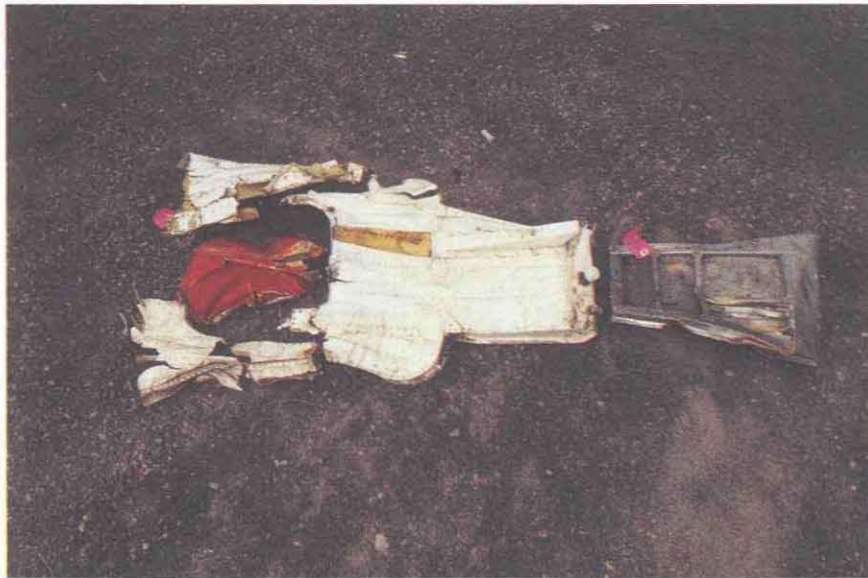
Left Main Gear Door
